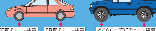
FF車チェーン装着 FR車チェーン装着 どちらか一方にチェーン装着
